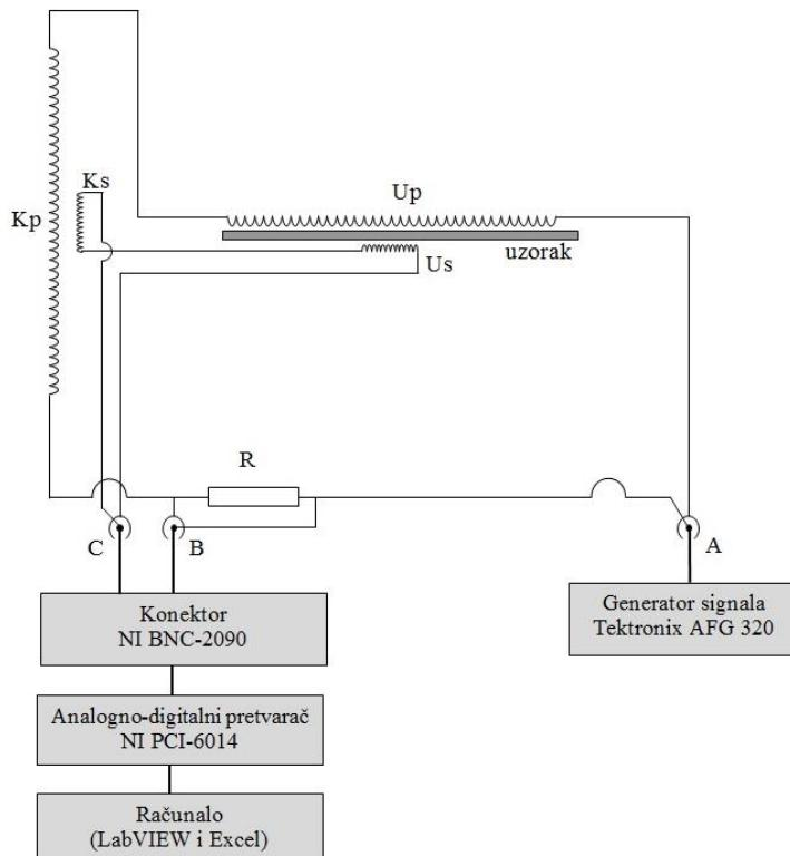
Slika 21: Shema eksperimentalnog postava za mjerjenje magnetskih svojstava amorfnih feromagnetskih vrpci. [4]
