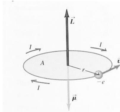
Slika 2: Prikaz magnetnog dipolnog momenta  $\vec{\mu}_L$  i kutne količine gibanja  $\vec{L}$  elektrona. [2]
