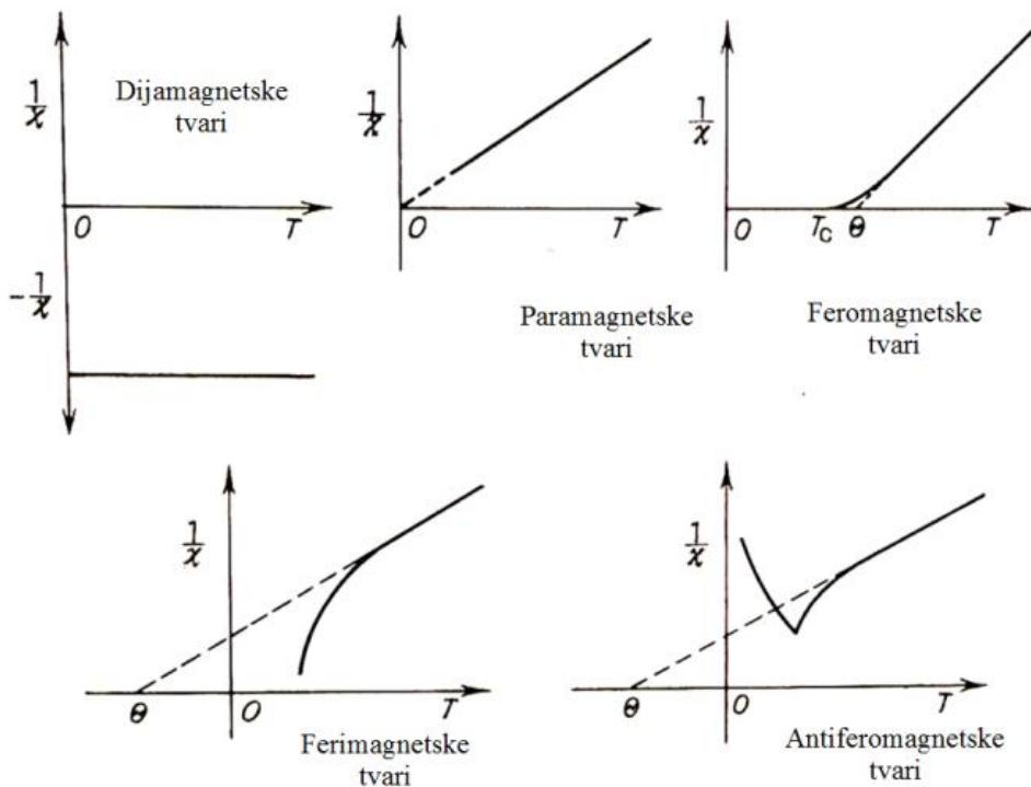
Slika 3: Prikaz ovisnosti recipročne magnetne susceptibilnosti o temperaturi za dane tvari. [7]
