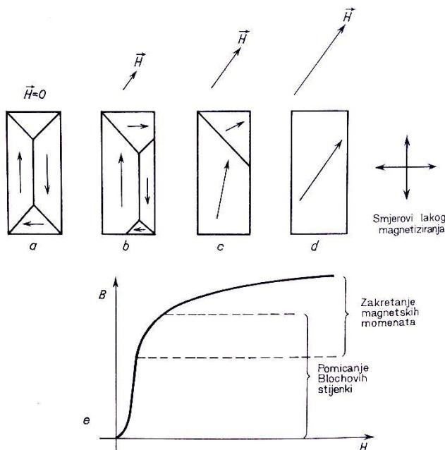
Slika 16: Proces magnetiziranja. *a* Nemagnetizirano stanje, *b* pomicanje domenskih zidova, *c* pomicanje domenskih zidova i zakretanje magnetnih momenata, *d* zakretanje magnetskih momenata do zasićenja. [7]
