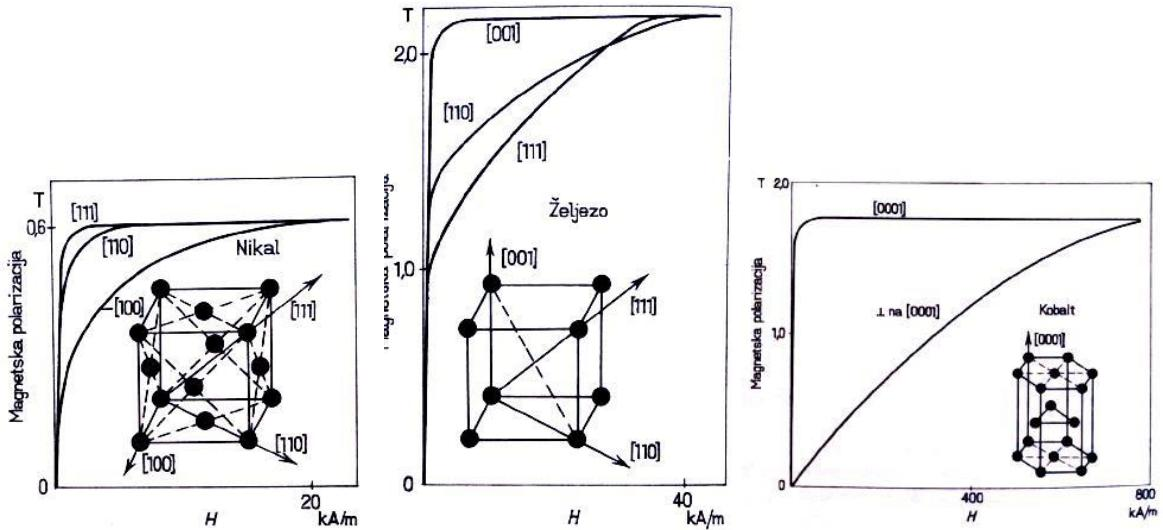
Slika 13: Prikaz krivulja magnetiziranja monokristala nikla, željeza i kobalta u ovisnosti o smjeru magnetnog polja. [7]
