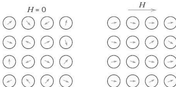
Slika 5: Prikaz magnetskih momenata kod paramagneta. [10]
