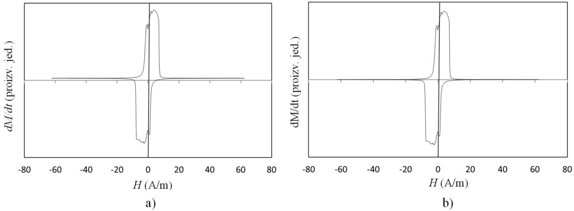
Slika 23: Ovisnost derivacije magnetizacija  $dM/dt$  o jakosti magnetskog polja  $H$  ( $f=27$  Hz,  $H_0=61.85$  A/m) a) prije i b) nakon uklanjanja offset-a (način uklanjanja offset-a opisan je u Dodatku B).
