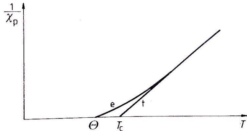
Slika 9: Grafički prikaz ovisnosti recipročne susceptibilnosti o temperaturi za feromagnete.
