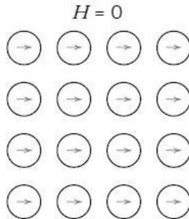
Slika 6: Prikaz magnetskih momenata unutar domene kod feromagneta. [10]
