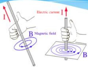
$$B = \mu_0 \mu_r \frac{I}{2\pi r} \quad \text{Magnetska indukcija na udaljenosti } r$$
