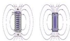
$$B = \mu_0 \mu_r \frac{NI}{l} \quad \text{Magnetska indukcija unutar zavojnice}$$
