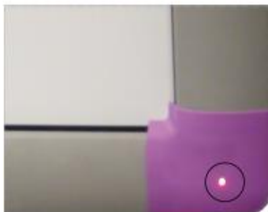
Slika 4. Crveno svjetlo koje ukazuje na napajanje putem USB kabla (Izvor: Turning Technologies, bez dat.)
