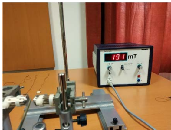
Slika 24: Mjerenje magnetskog polja između neodimijskih magneta
