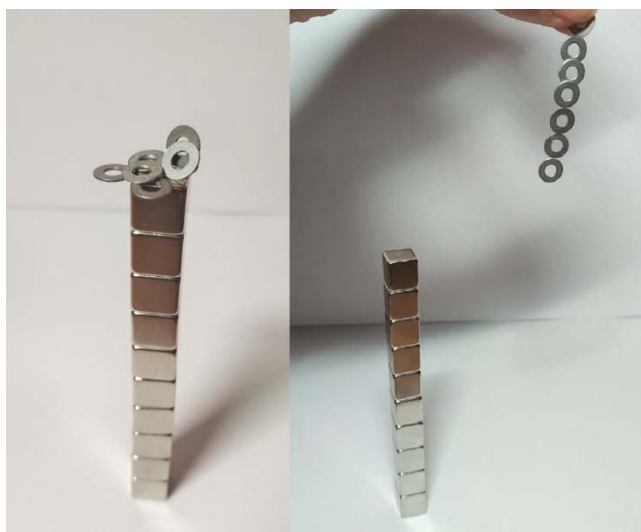
Slika 20: Prikaz prisutnosti magnetizacije feromagnetu i nakon odmaknuta od magnetu
