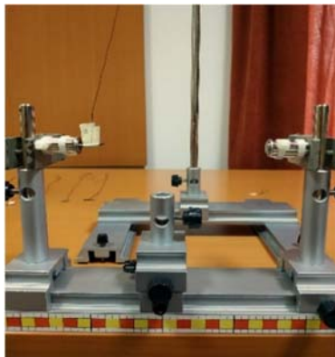
Slika 30: Ponašanje uzorka željeza u magnetskom polju
