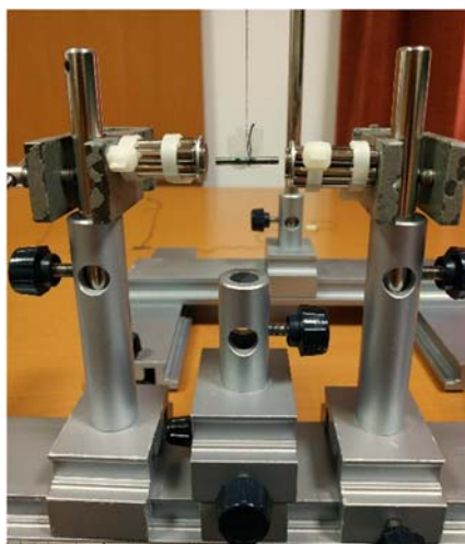
Slika 32: Ponašanje uzorka volfama u magnetskom polju
