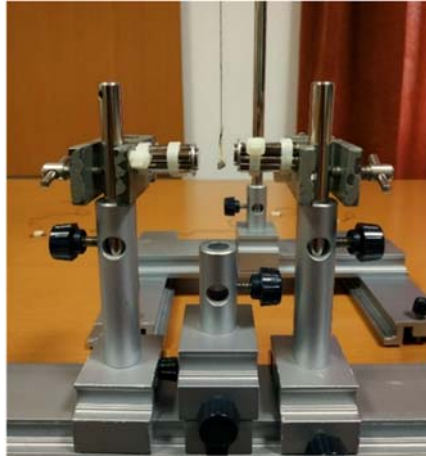
Slika 40: Ponašanje uzorka bizmuta u magnetskom polju
