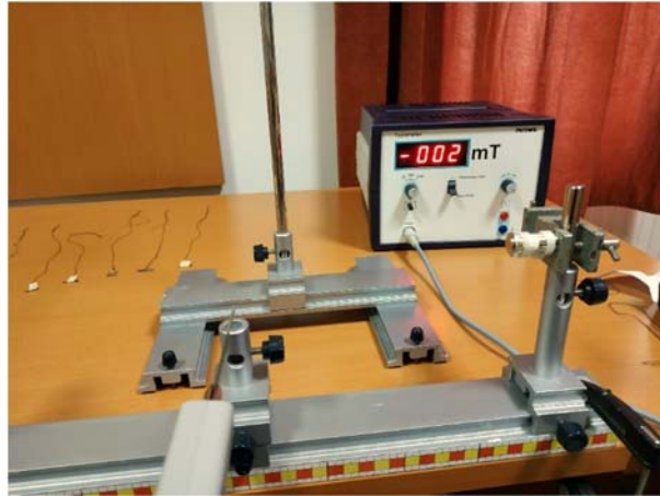
Slika 23: Mjerenje magnetskog polja prije primijene polja
