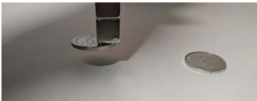
Slika 19: Približavanje magnetu kovanici od 50 lipa (feromagnet)
