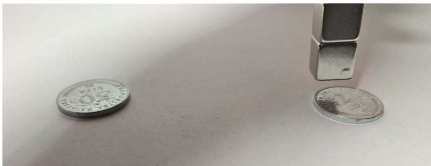
Slika 18: Približavanje magneta kovanici od dvije lipe (paramagnet)
