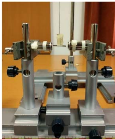
Slika 36: Ponašanje uzorka bakra u magnetskom polju
