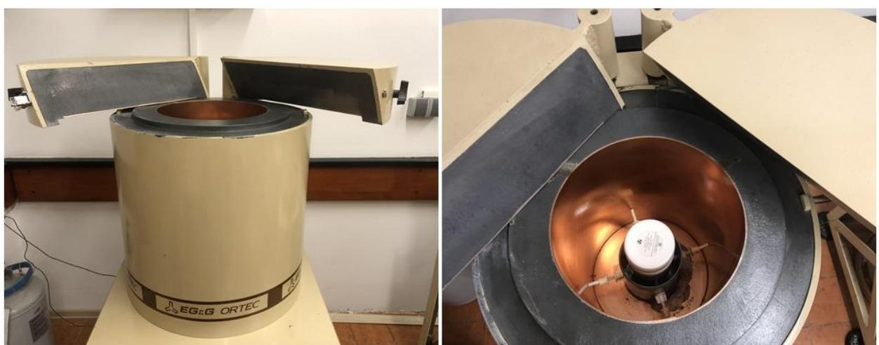
Slika 19: Ortec HPGe Gama-spektrometar
