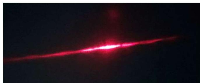
*Slika 20. Interferencijski uzorak svjetlosti na paru linija s iznimno malim međusobnim razmakom*
