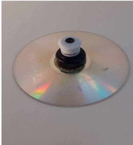
Slika 7. Čep zalijepljen na otvor CD-a
