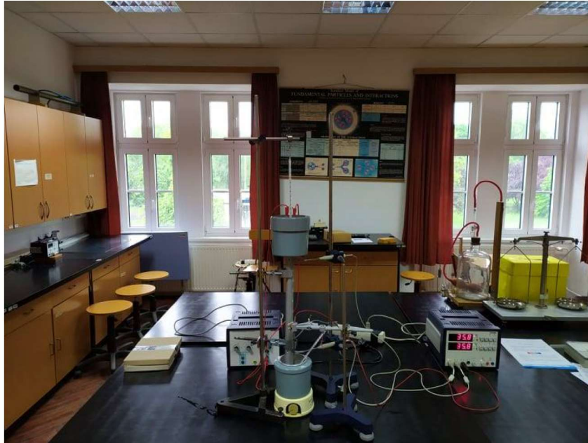
Slika 8: Aparatura za određivanje toplinske vodljivosti aluminijske šipke
