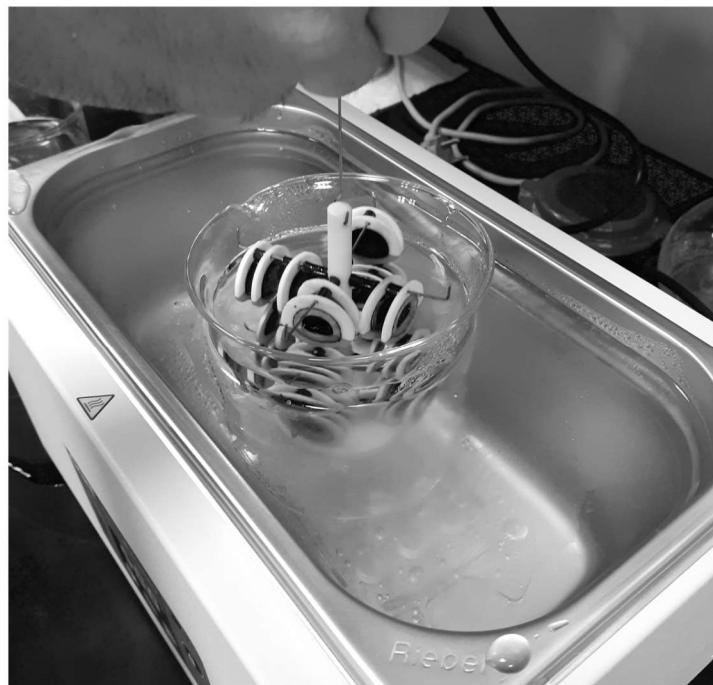
**Slika 5.8.:** Uranjanje stalka s filmovima u posudu s vodenom otopinom  $\text{NaOH}$  unutar kalorimetra. Za vrijeme jetkanja, kalorimetar je poklopljen radi što stabilnije temperature unutar njega.
