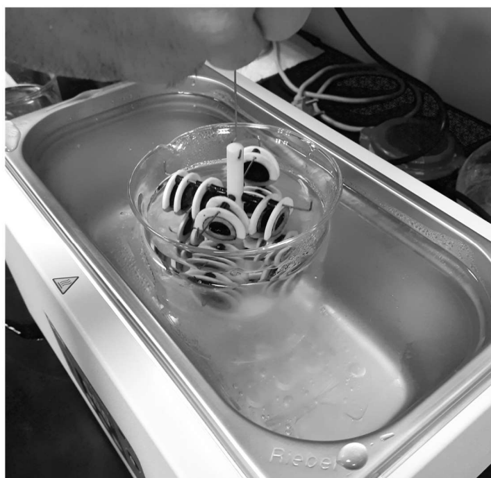
Slika 5.8.: Uranjanje stalka s filmovima u posudu s vodenom otopinom NaOH unutar kalorimetra. Za vrijeme jetkanja, kalorimetar je poklopljen radi što stabilnije temperature unutar njega.
