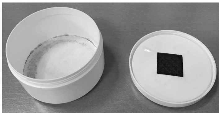
Slika 5.1.: Pasivni mjerni uređaj korišten u ovom radu. S lijeve strane slike je plastična posuda na čijem se dnu nalazi otvor prekriven tankom difuzijskom membranom, a s desne strane poklopac s detektorom. Posuda je tijekom mjerenja zatvorena.
