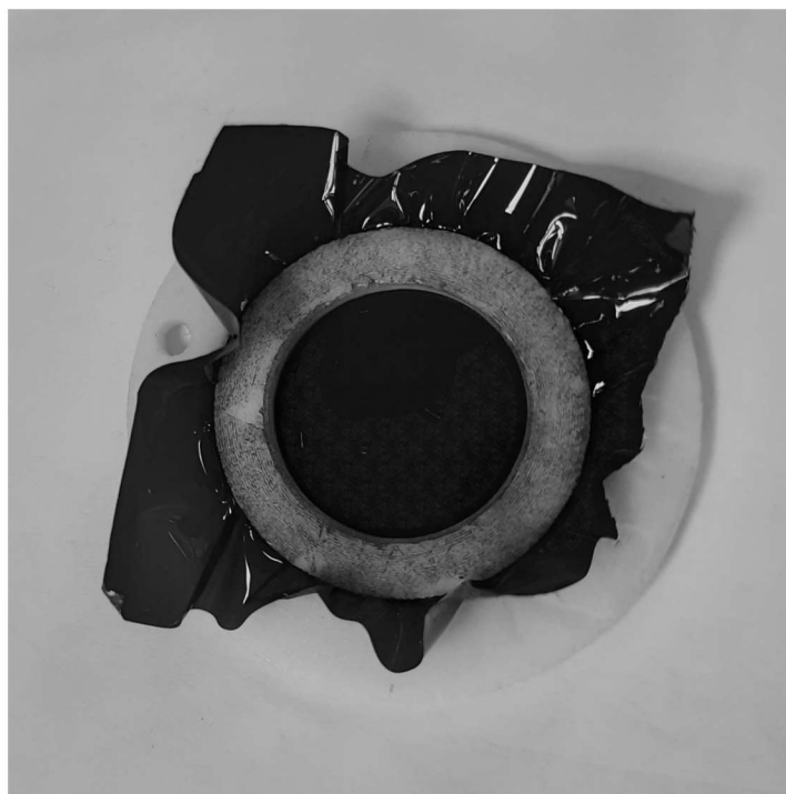
Slika 5.7.: Neodrezani detektorski film LR 115 tipa II na prstenu za brojanje koji ima rupicu slijeva kako bi se mogao ovjesiti o stalak za pranje, jetkanje i sušenje.
