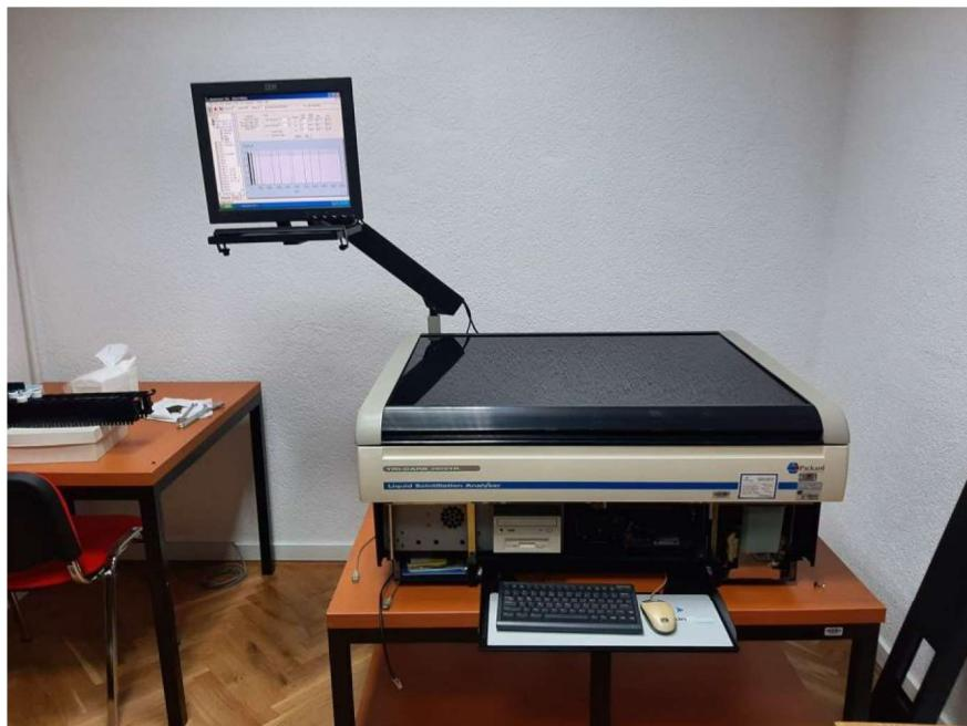
Slika 24. Scintilacijski detektor TriCarb2900.
