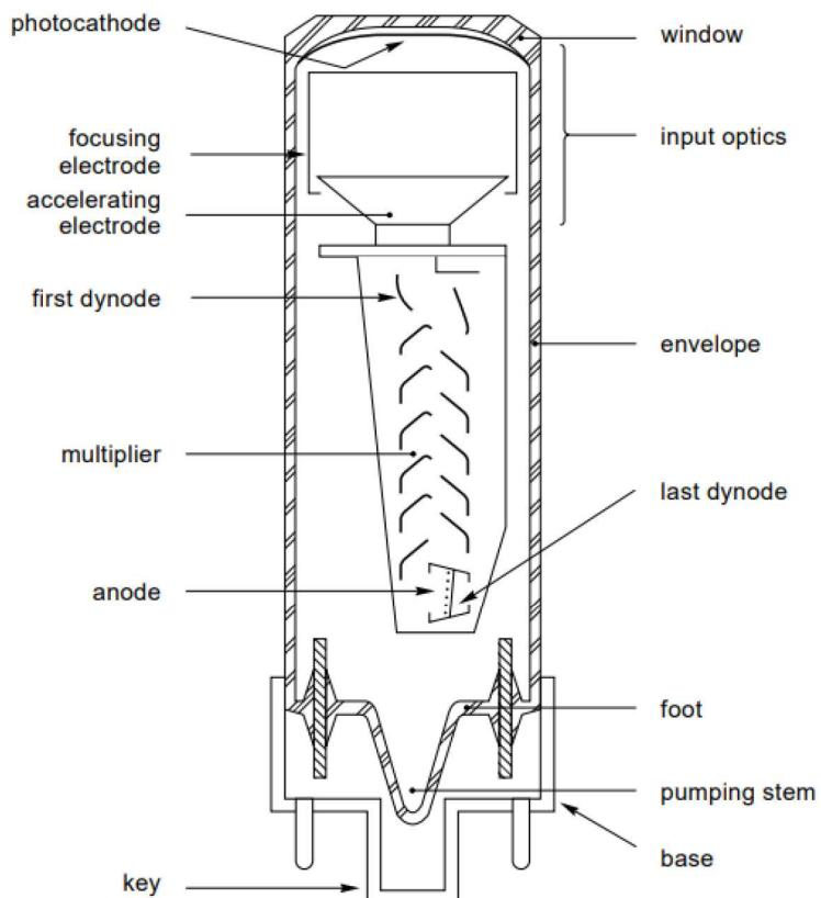
Slika 20. Shematski prikaz fotomultiplikatora<sup>11</sup>.
