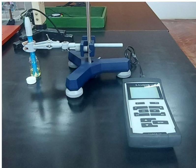
Slika 30. pH-metar *HandiLab 100*, SI Analytics (XYLEM Analytics, Njemačka).
