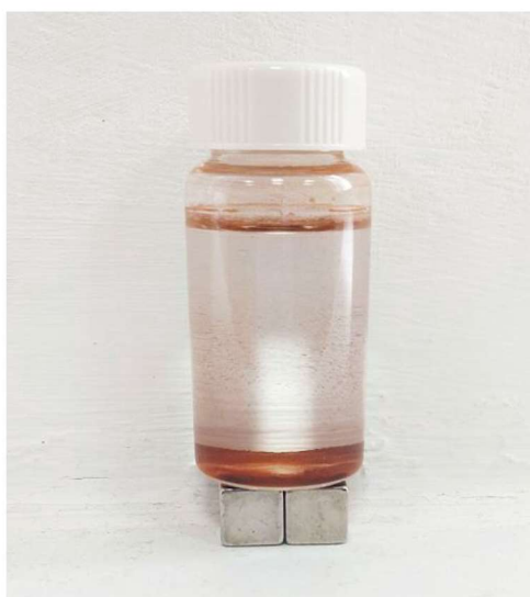
Slika 33. Uzorak nakon magnetskog razdvajanja s neodimijskim magnetom.
