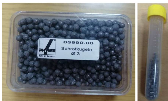
Slika 27. a) Olovna sačma i b) Olovna sačma u epruveti korištena u pokusima 1.
