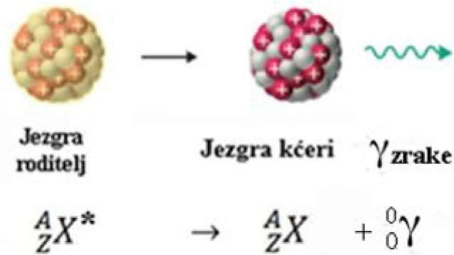
Slika 14. Slikoviti prikaz \gamma raspada. Jezgra roditelj ( {}^A_Z X^* ) raspada se na jezgru kćer ( {}^A_Z X ) emitirajući foton ( {}^0_0 \gamma ). [28]
