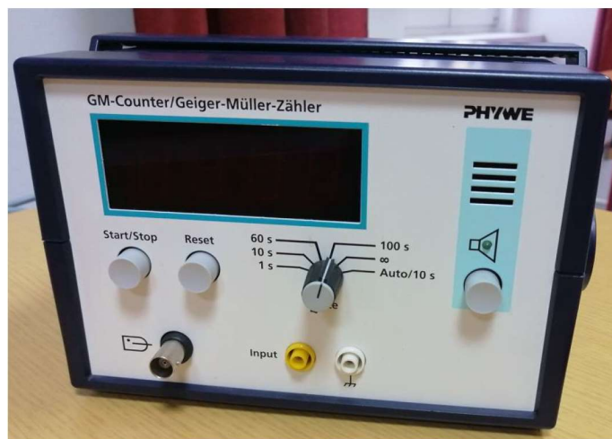
Slika 22. Geiger-Müllerov brojač proizvođača PHYWE.
