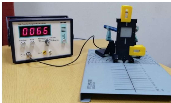
Slika 33. Eksperimentalni postav modela radioaktivnog refleksijskog debljinomjera.
