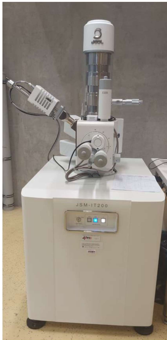
Slika 5: JEOL skenirajući elektronski mikroskop
