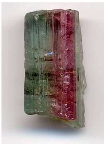
Slika 7. Turmalin; kristal s piroelektričnim svojstvima [7]
