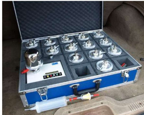
Slika 9. RM-2 detektor radona [34]
