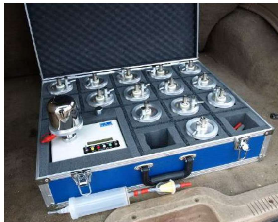
Slika 9. RM-2 detektor radona [34]
