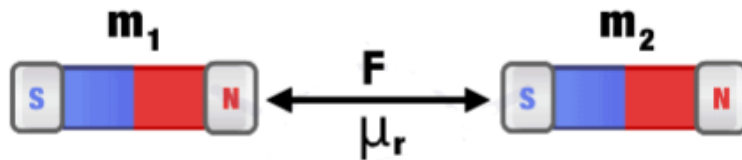
Slika 6. Prikaz dva magnetska pola ( m_1, m_2 ) koja se međusobno privlače silom iznosa F , a nalaze se u sredstvu relativne permeabilnosti \mu_r [14].
