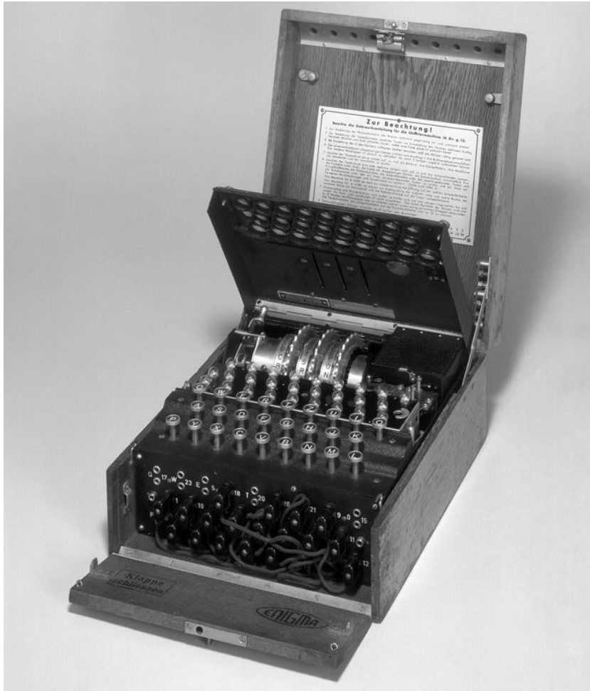
Slika 11. Enigma s tri rotora
