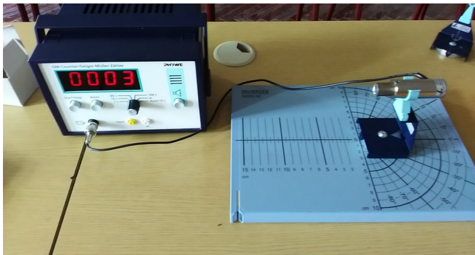
Slika 31. Demonstracijska ploča na koju je postavljen držač ionizacijske komore te ionizacijska komora tipa B koja je spojena na Geiger – Müllerov brojač
