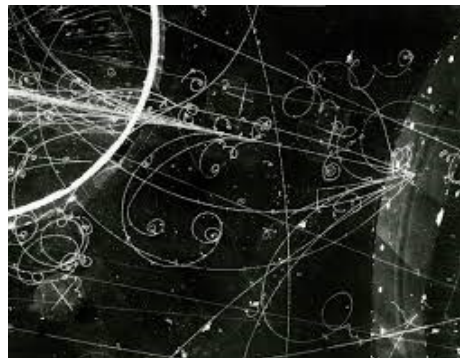
Slika 15. Prikaz putanje čestica pomoću komore na mjehuriće [22]
