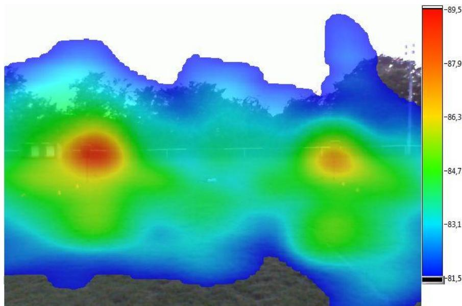
**Slika 29.** Akustička slika kada zvučnici rade istovremeno
