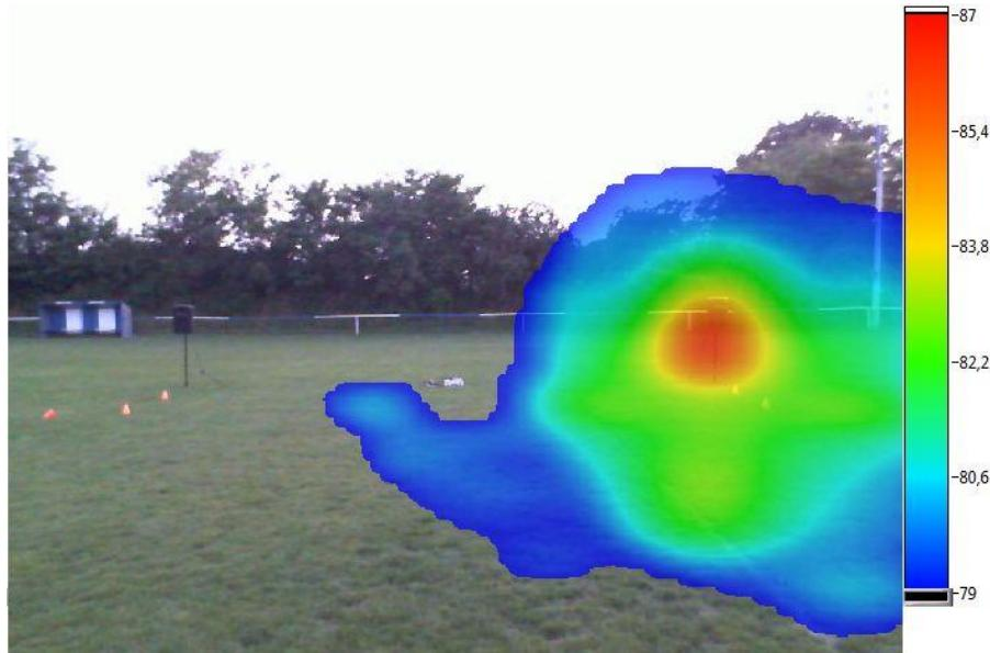
**Slika 26.** Akustička slika desnog zvučnika ( $d=18,48$ m).
