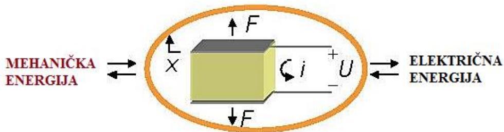
**Slika 20.** Piezoelektrični efekt [2]
