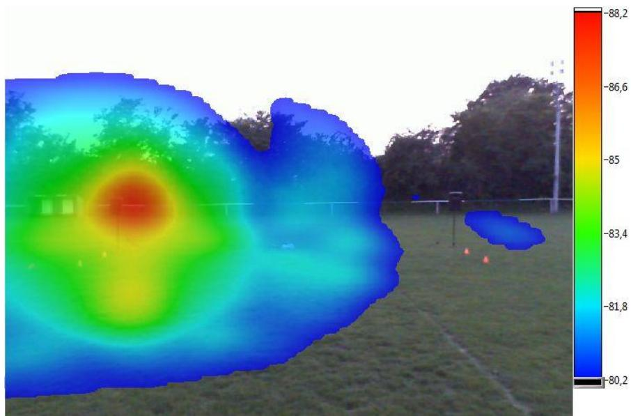
**Slika 28.** Akustička slika lijevog zvučnika ( $d=19,14$ m)
