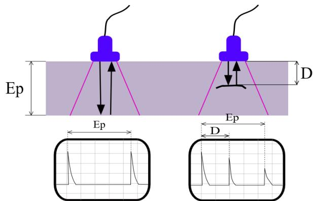
**Slika 22.** Ultrazvučno testiranje [50]
