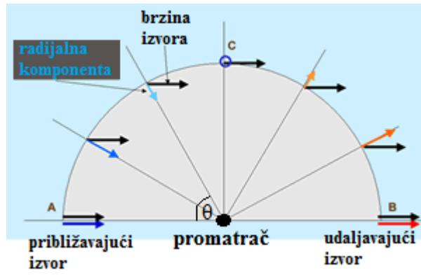
**Slika 10.** Rastav brzina gibajućeg izvora u odnosu na mirujućeg promatrača. Za Dopplerov efekt bitna je samo radijalna komponenta brzine. [4]
