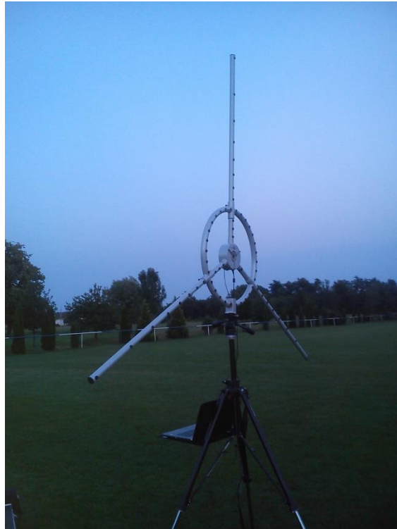
Slika 24. Akustička kamera korištena u mjerenjima
