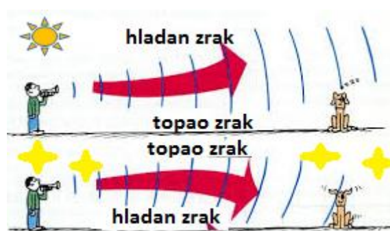
Slika 8. Smjer širenja zvučnih valova u ovisnosti o dobu dana [49]
