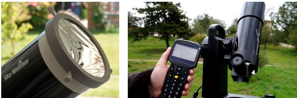
Slika 18. Dodatna oprema za vrijeme promatranja tranzita Merkura; solarni filter (lijevo), Go To sustav (desno)
