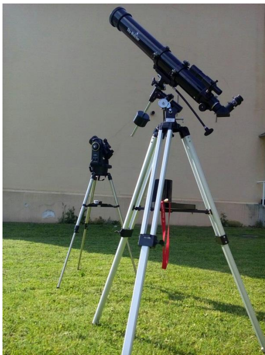
Slika 16. Teleskopi upotrijebljeni za promatranje tranzita Merkura. Desno se nalazi refraktorski Skywatcher, a lijevo mješoviti National Geographic Automatic teleskop ( Autor fotografije: Vukić, M. )
