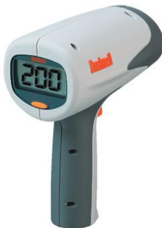
Slika 6. Policijski pištolj za mjerenje brzina vozila [10]
