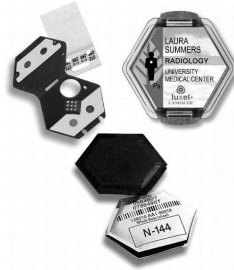
Slika 63. Optički stimuliran dozimetar [4]
