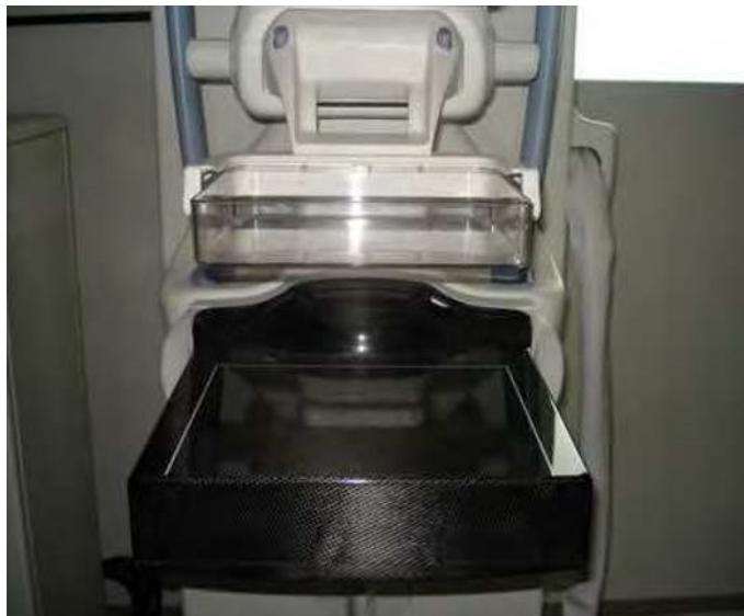
Slika 55. FFDM detektorski sustav [19]
