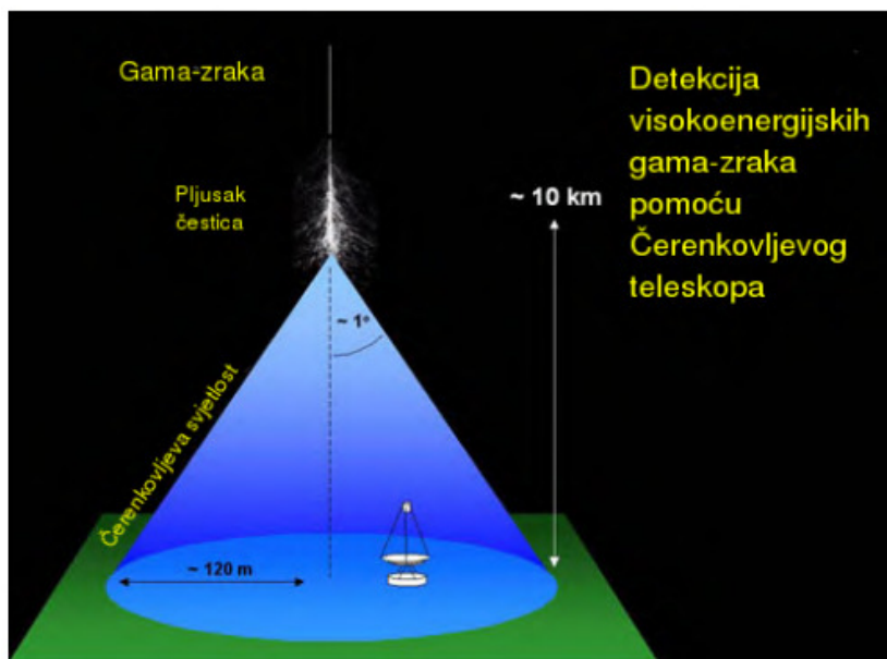
Slika 4. Detekcija visokoenergijskih gama-zraka. Izvor: http://lapp.irb.hr/publications/IvaDiploma.pdf .
