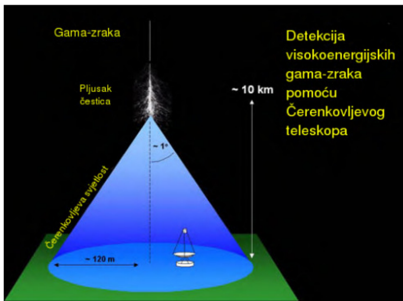
Slika 4. Detekcija visokoenergijskih gama-zraka. Izvor: http://lapp.irb.hr/publications/IvaDiploma.pdf .
