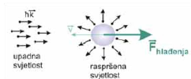
Slika 4.6.1. Smjer sile hlađenja određen je smjerom upadnih fotona. Na atome koji se gibaju prema laserskom zračenju djeluje sila koja ih gura u suprotnom smjeru [14]
