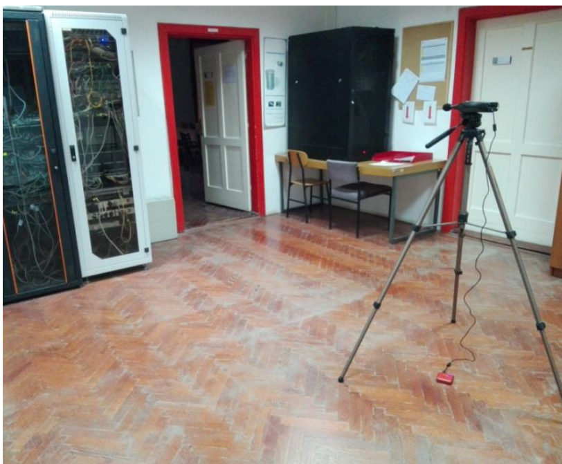
Slika 30. Postavljanje zvukomjera i mjerenje razine intenziteta zvuka
