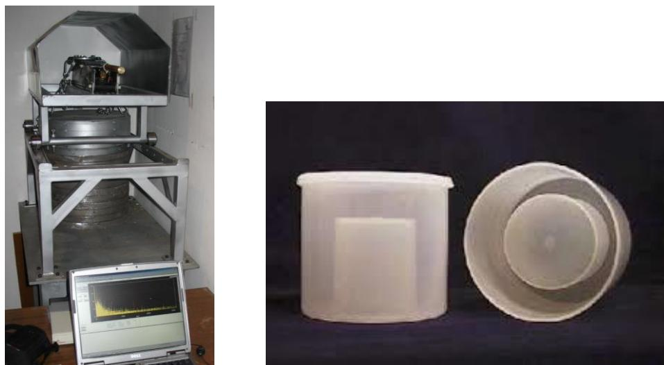
Slika 17. Mjerni uređaj HPGe Gama spektrometar (slika desno: pripadajuća Marineli posuda za tekućinu)
