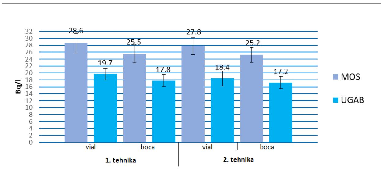
**Slika 31.** Grafički prikaz rezultata mjerjenja (te standardne devijacije pojedinih mjerjenja) koncentracija aktivnosti radona u uzorcima vode sa izvora Spens dobiveni pomoću LSC Quantulus uređaja pri čemu je voda uzorkovana u mjerne staklene bočice i obične plastične boce (korištene obje tehnike)
