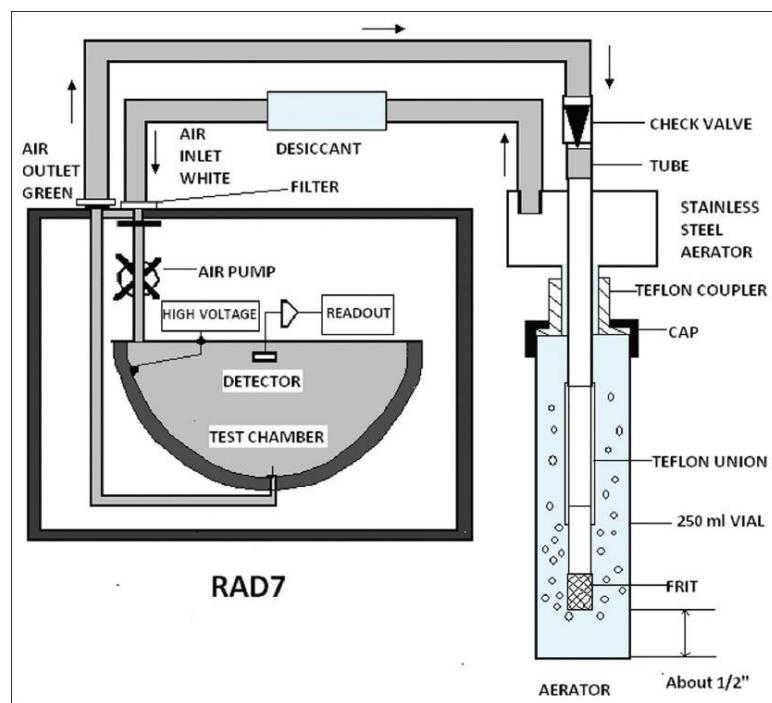
**Slika 10.** Shema unutrašnjosti uređaja RAD 7 za mjerjenje radona u vodi
