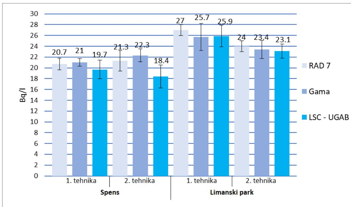
**Slika 29.** Grafički prikaz rezultata mjerjenja koncentracija aktivnosti radona (te standardne devijacije pojedinih mjerjenja) u uzorcima vode sa izvora u Limanskom parku te Spens (koristiene obje tehnike)
