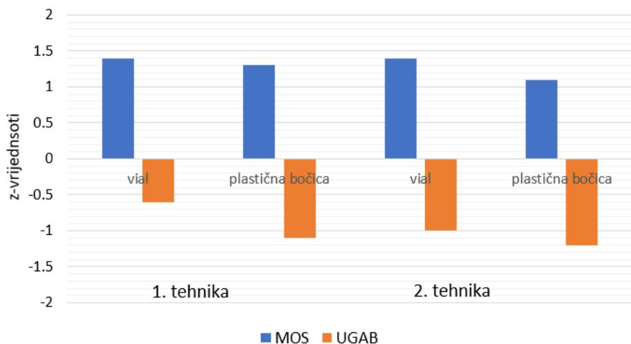
**Slika 30.** Prikaz z-vrijednosti rezultata dobivenih mjerjenjima uzoraka vode sa izvora Spens (Novi Sad) LSC metodom (vial/plastična bočica)
