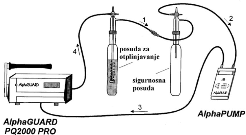
**Slika 8.** Mjerenje radona u vodi pomoći AlphaGUARD mjernog sustava
