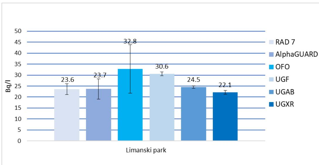
**Slika 36.** Grafički prikaz rezultata interkomparacije (te standardne devijacije pojedinih mjerena) u uzorcima vode sa izvora Limanski park dobiveni pomoću RAD 7, AlphaGUARD, LSC Quantulus te LSC TriCarb (uzorkovano prvom tehnikom)
