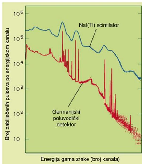
**Slika 16.** Na slici se nalaze dva spektra koji prikazuju rezultat mjerjenja germanijskim i scintilacijskim detektorom gdje se vidi znatno veća razlučivost poluvodičkog germanijskog detektora - scintilacijski detektor ne razlikuje bliske linije u spektru već ih svrstava unutar zajedničkog vrha u spektru
