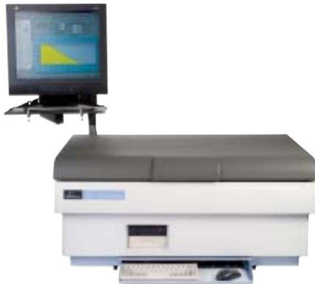
**Slika 25.** Tekućinski scintilacijski detektor TriCarb 2900
