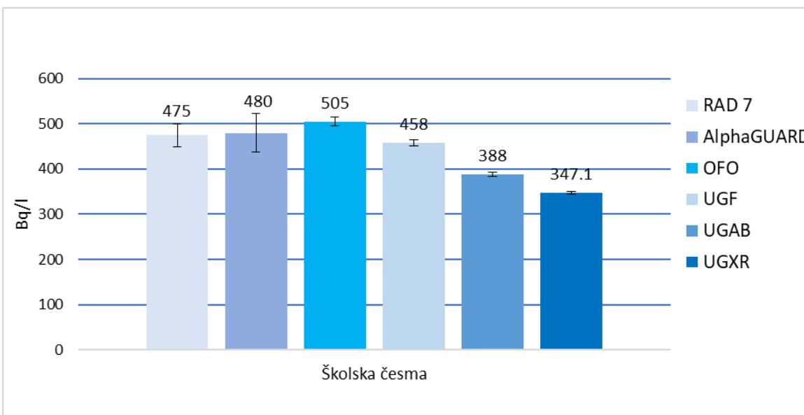
**Slika 35.** Grafički prikaz rezultata interkomparacije (te standardne devijacije pojedinih mjerena) u uzorcima vode sa izvora Školska česma dobiveni pomoću RAD 7, AlphaGUARD, LSC Quantulus uređaja pri čemu se za pripremu uzorka koristilo tri scintilacijska koktela: OFO, UGF, UGAB, te LSC TriCarb gdje se kao scintilacijski koktel koristio UGXR (Ultima Gold XR) (uzorkovano prvom tehnikom)
