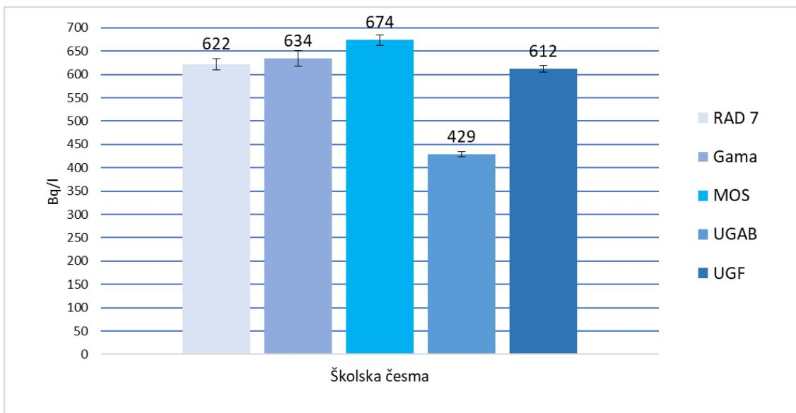
**Slika 33.** Grafički prikaz rezultata mjerena koncentracija aktivnosti radona (te standardne devijacije pojedinih mjerena) u uzorcima vode sa izvora „školska česma“ dobiveni pomoću LSC Quantulus uređaja pri čemu se za pripremu uzorka koristilo tri scintilacijska koktela: MOS, UGAB, UGF (uzorkovano prvom tehnikom), radi usporedbe su prikazani rezultati dobiveni uređajima RAD 7 i HPGe Gama spektrometrom
