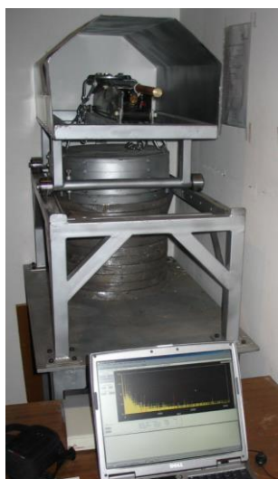
Slika 17. Mjerni uređaj HPGe Gama spektrometar (slika desno: pripadajuća Marineli posuda za tekućinu)
