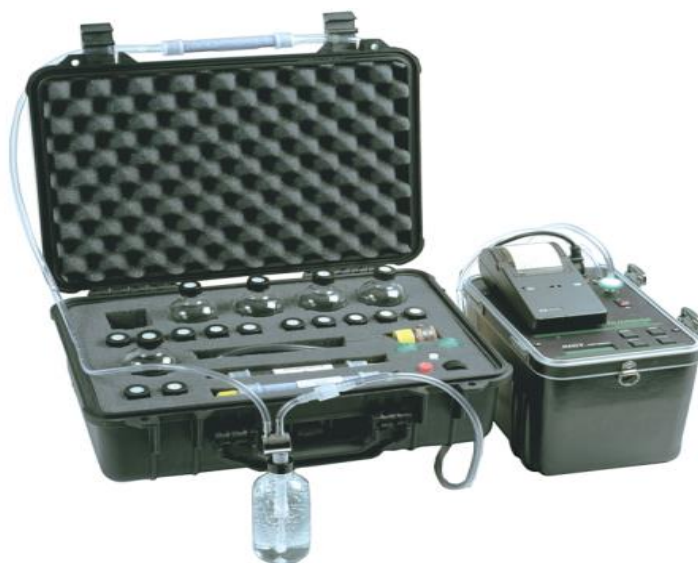
Slika 11. Mjerenje radona u vodi pomoći Alfa spektrometra DURRIDGE RAD 7
