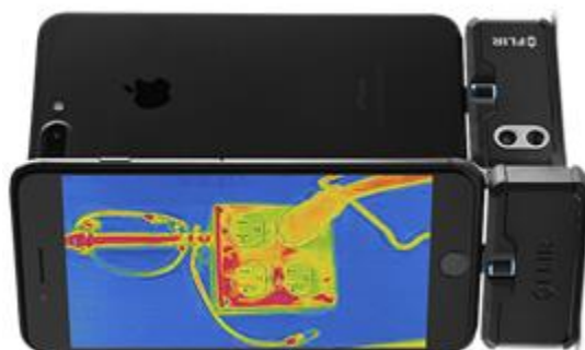
Slika 30. Termalna kamera za mobitele [30]
