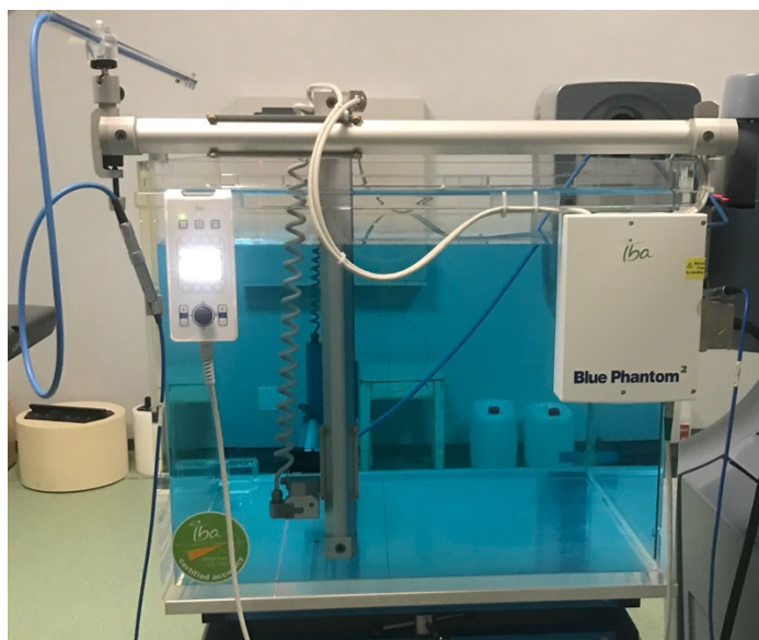
Slika 27: Fotografija vodenog fantoma Blue Phantom 2 (IBA)
