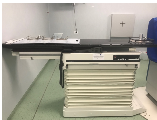
Slika 12. : Terapijski stol medicinskog linearnog akceleratora
