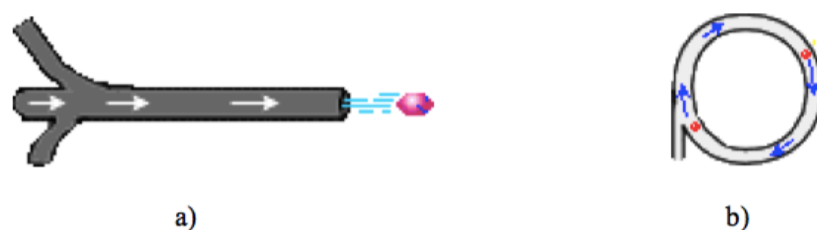
Slika 1. : a) Linearni akcelerator, b) Kružni akcelerator
