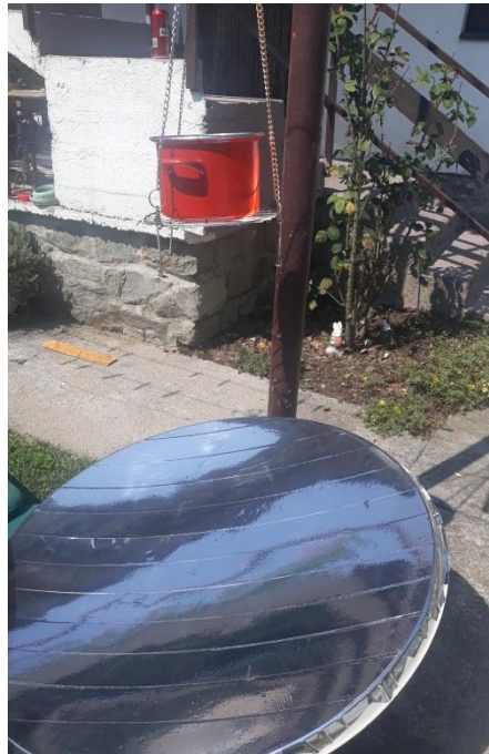
Slika 44. Parabolično zrcalo kao solarno kuhalo
