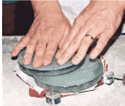
Slika 17. Izrada paraboličnog zrcala [2]
