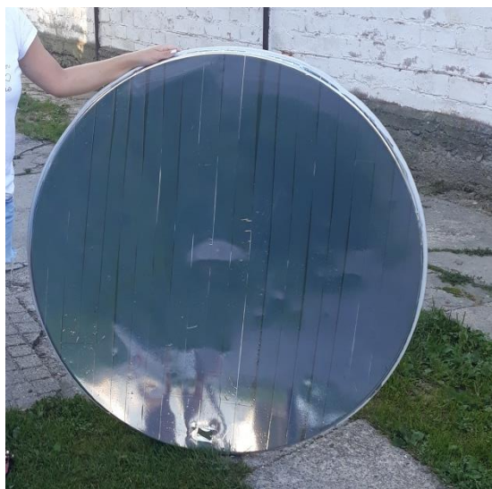
Slika 36. Satelitska antena polijepljena visokom reflektirajućom folijom
