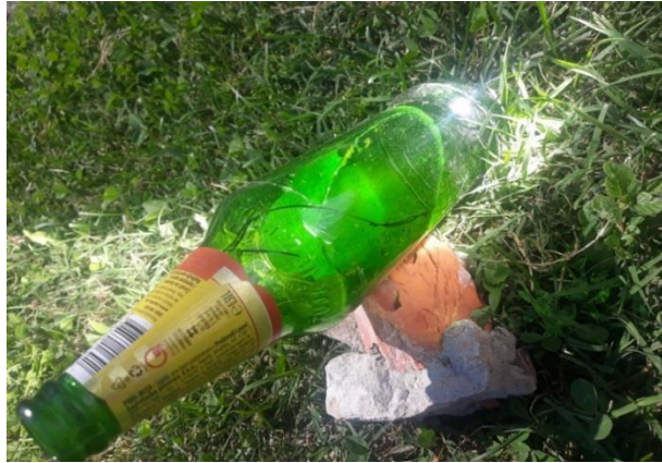
Slika 45. Prikaz napuknute staklene boce zbog visoke temperature
