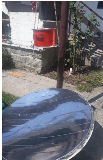
Slika 44. Parabolično zrcalo kao solarno kuhalo
