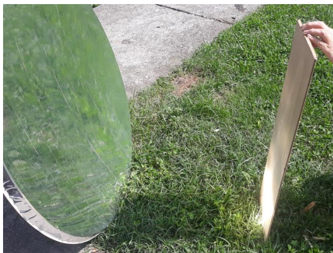
Slika 38. Određivanje vrijednosti žarišta paraboličnog zrcala
