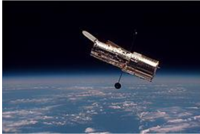
Slika 27. Hubbleov svemirski teleskop – najveći satelitski reflektorski teleskop [25]
