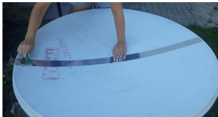
Slika 35. Lijepljene folije po satelitskoj anteni
