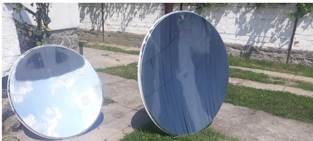
Slika 47. Parabolična zrcala napravljena od različitih visoko reflektirajućih folija
