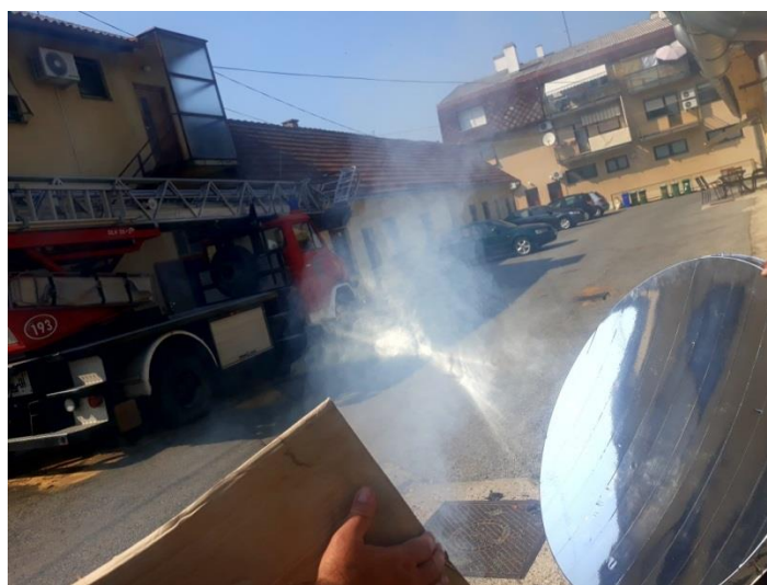
Slika 37. Žarište paraboličnog zrcala
