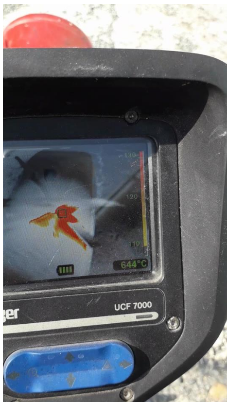
Slika 43. Prikaz temperature paljenja drvene letve
