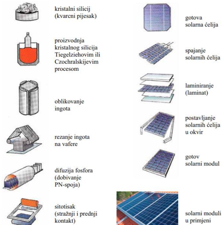
Slika 14. Postupak proizvodnje ćelija i solarnih panela [2]
