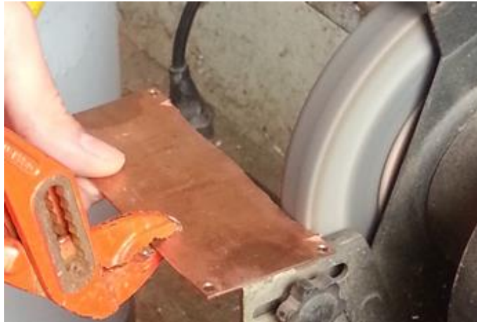
Slika 20. Dorada metalne pločice
